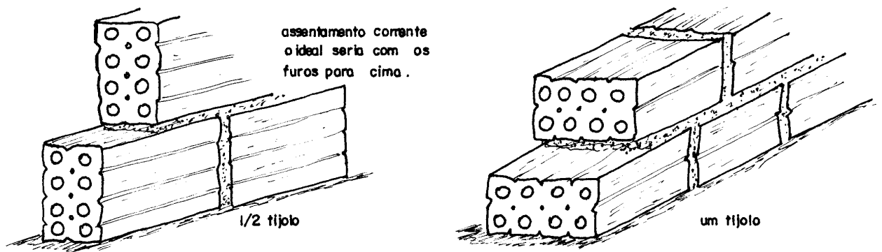
Figura 1 - Execução de alvenaria utilizando tijolos furados.
