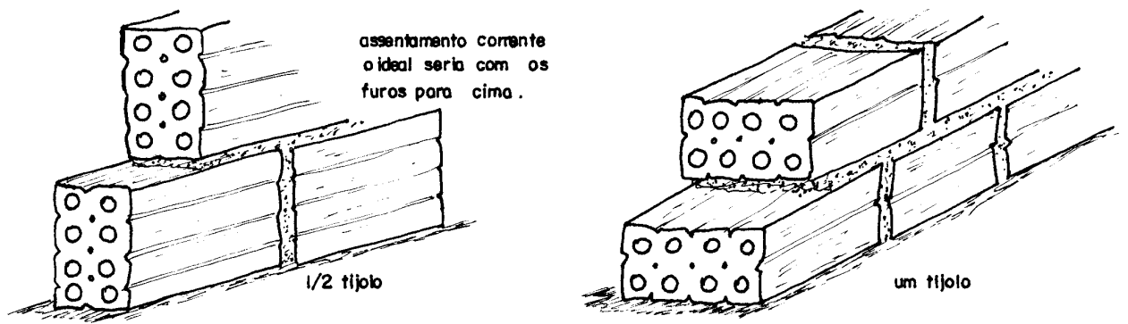
Figura 1 - Execução de alvenaria utilizando tijolos furados.
